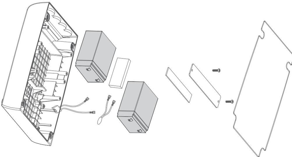
Il est possible de brancher un jeu de batterie pour faire fonctionner le portail, même en cas de coupure de courant (Autonomie de 5 jours maximum)
