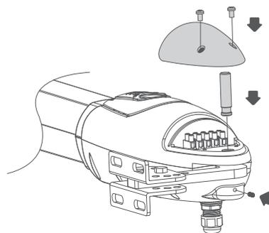
4. Monter l'étrier avant sur la fixation avant du moteur (figure 3).
