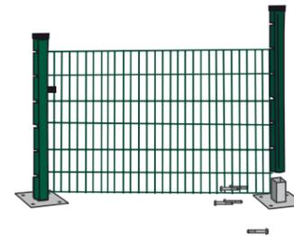
7/ En cas d'ancrage avec une platine au lieu d'une fondation, vissez la base et insérez le premier poteau. Accrochez le panneau et insérez le poteau suivant.
