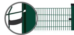
4/ Placez les clés Ritmo pour fixer les panneaux pendant que le béton à la base du poteau durcit.
